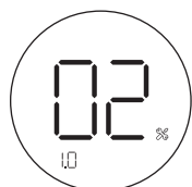
Рис. 20. Настройка отопительной кривой.
